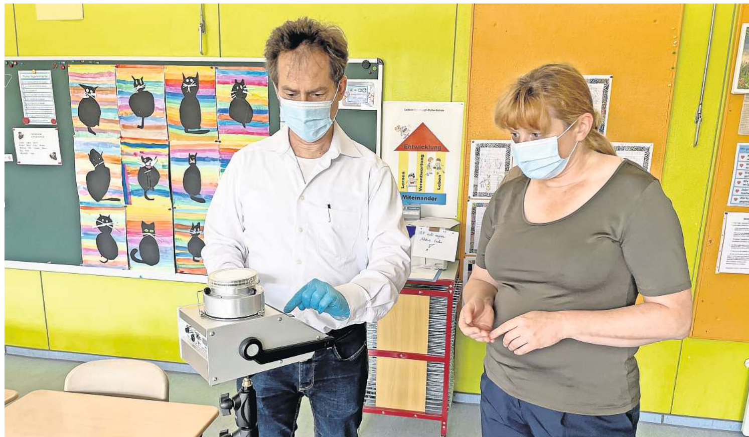
Wolfgang Karl Hofbauer und Andrea Burdack-Freitag vom Fraunhofer-Institut nehmen die Messungen im Klassenzimmer der Grundschule Groß Düngen vor. Sie testen die Wirksamkeit von Luftreinigern, die mit Plasmatechnik arbeiten. FOTO: ULRIKE KOHRS
